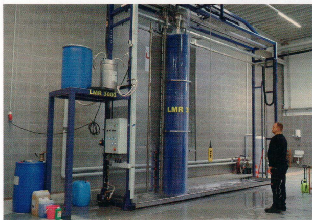
Lindner Rido reinigt Aluminiumlamellen mit dem stationären Reinigungssystem LMR 3000 von SPS-Cleaning-Systems.
