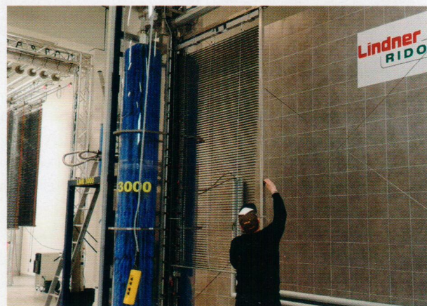
Vor dem Waschvorgang werden die Jalousien eingespannt. Das System kann eine Lamellenbreite von 16-100 mm reinigen.
