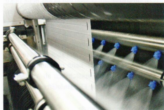
Der Plisseevorhang wird vollautomatisch und formstabil gereinigt.
