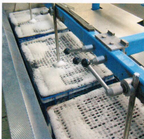
Vertikallamellen werden im hubmechanischen Reinigungsverfahren gewaschen.
