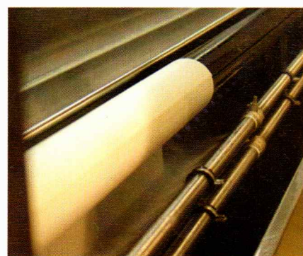
Ein Rollo wird durch Bürstenwalzen gereinigt.
