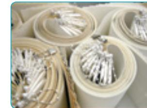
Die gerollte Bearbeitung der Lamellen verhindert eine Beschädigung der Kanten und ein Knicken der Lamellen.
