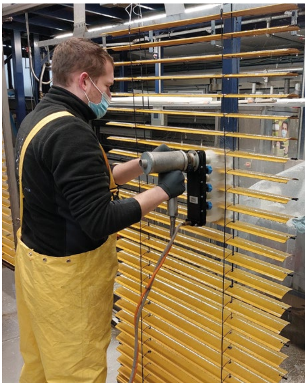
Die rotierenden Bürstenwalzen des mit Elektromotor angetriebenen mobilen Systems entfernen auch hartnäckigen Schmutz.
