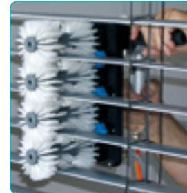
**Rotierende Bürstenwalzen** reinigen gleichzeitig die Ober- und Unterseiten der Lamellen. Zug- und Leitbänder werden mitgereinigt. Die Reinigung sorgt damit auch für den Werterhalt und eine fehlerfreie Funktion der Jalousie.
