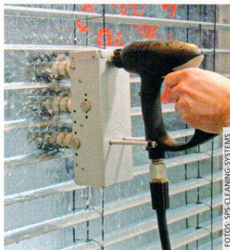
Der HD-Vario-3-Jalousienreiniger – nur mit Wasserdruck angetrieben. Mit maximal 10 bis 15 Quadratmetern Reinigungsleistung gut für kleine und mittlere Objekte geeignet.
