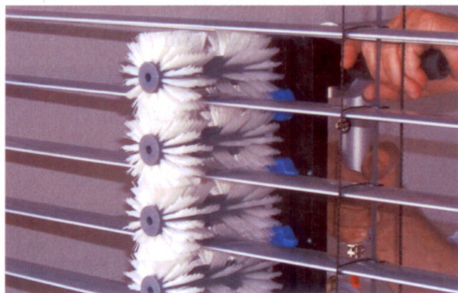
Mit der AJR professional lassen sich zwischen 15 und 25 m 2 pro Stunde reinigen
