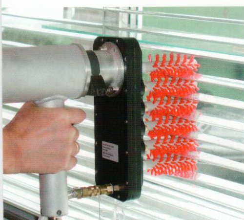
Die Reinigung mit Spezialbürsten schont die hochreflektierende Oberflächenbeschichtung von TLT-Jalousien
