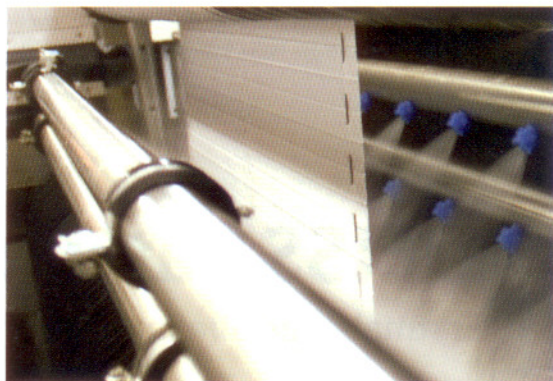
Plisse wird im Vollautomat TFR 2200 formstabil gereinigt
