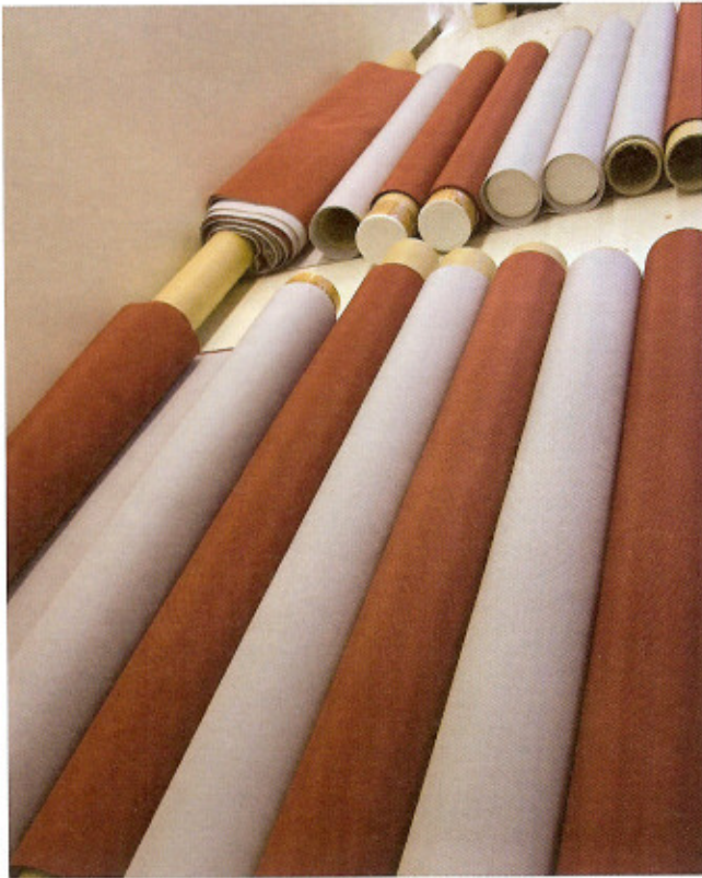
Die Vorhänge werden auf spezielle Rollen (ca. 25 cm Durchmesser) gewickelt, damit ist gewährleistet, dass sie auch faltenfrei bleiben. Fotos: Sps-cleaning-systems
