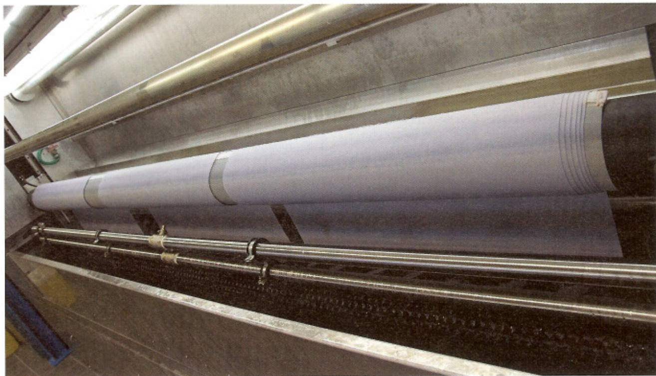
Bei größeren Stückzahlen kommt die Breite von 2,5 m der TFR 2200 voll zur Geltung, da zwei oder sogar drei Bahnen nebeneinander eingelegt werden können. Foto: Sps-cleaning-systems
