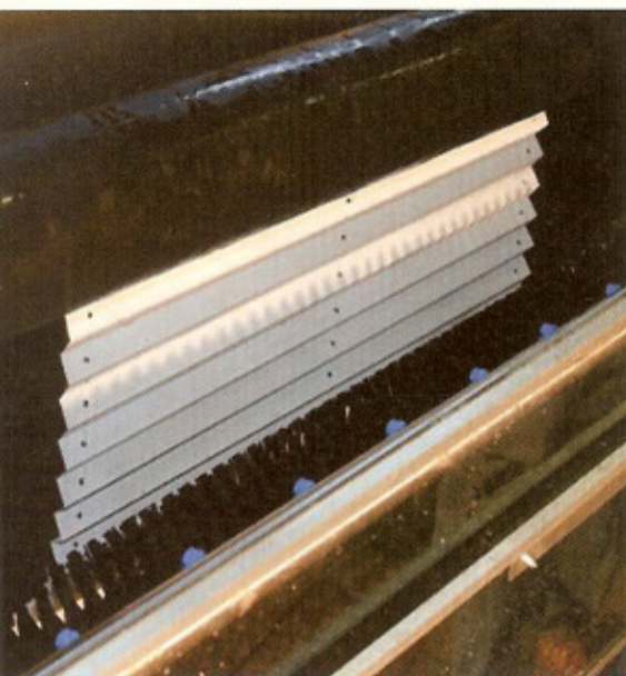
Plisseevorhang wird durch Bürstenwalzen gereinigt. Vorhang wird in TFR 2200 eingelegt. Spezialbürsten sorgen für optimale Tiefenreinigung.
